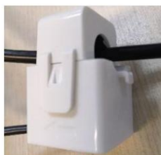
FIG.8 Instale o CT
