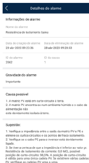
Figura E-1 Detalhes do alarme
